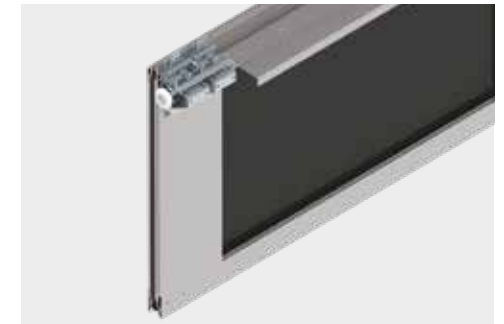
Dubbele zijstijl + zijscharnieren met vin en AR- versteving (vanaf 6000 mm)
